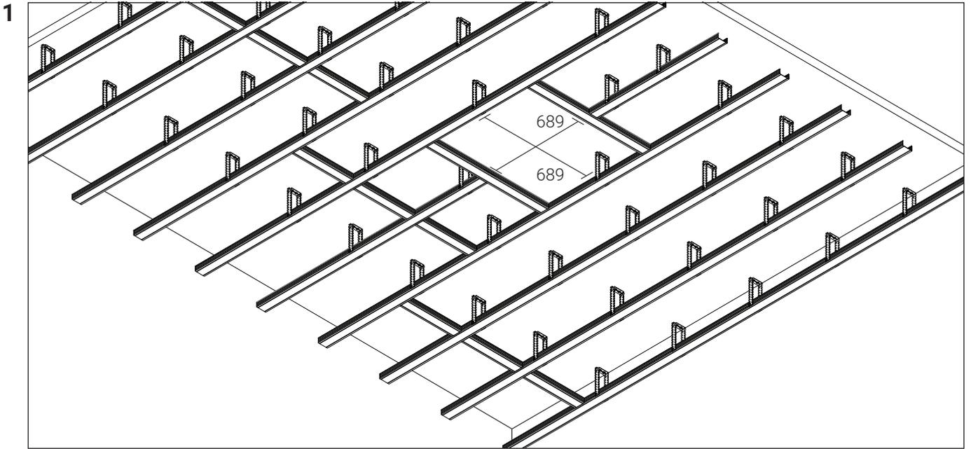
При установке металлоконструкции потолка осуществите монтаж каркаса для крепления гипсового корпуса светильника: предусмотрите расстояние между направляющими 689х689 мм.
