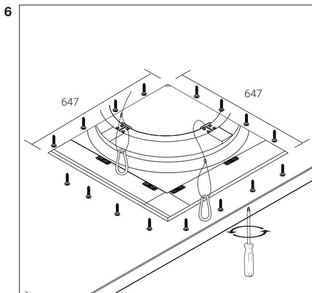
Сделайте отверстие в листе гипсокартона, соответствующее размерам выбранной модели светильника 647x647 мм. Прикрепите лист гипсокартона к металлическим направляющим с помощью саморезов.
