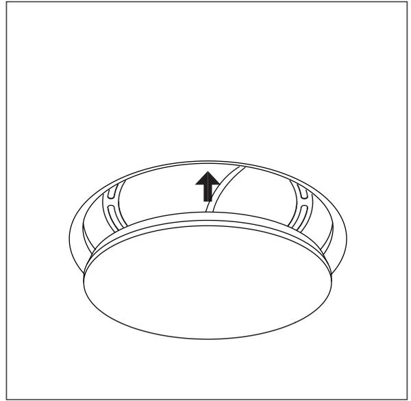
Установите световой модуль в корпус светильника
